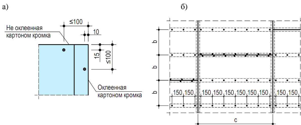
Рисунок 42 – Схема расположения самонарезающих винтов на краях гипсокартонных листов (а) и схема закрепления гипсокартонных или гипсоволокнистых листов к каркасу с помощью самонарезающих винтов (б)
